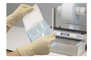
Данное испытание должно выполняться **ежедневно**, желательно перед началом рабочего дня: Испытываемый герметичный шов должен быть полностью завершенным и выглядеть одинаково по всей длине.
