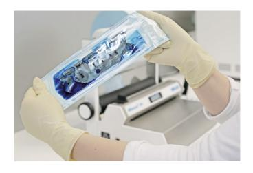
**MELA***ink* — надежный способ проведения **еженедельных** проверок герметичности швов на наличие утечек в соответствии со стандартами DIN EN ISO 11607-1 и ASTM F1929-12.
