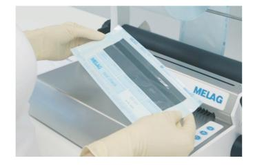
**Еженедельный** контроль герметичных швов проверяет их качества в соответствии с требованиями стандарта DIN EN ISO 11607-2.
